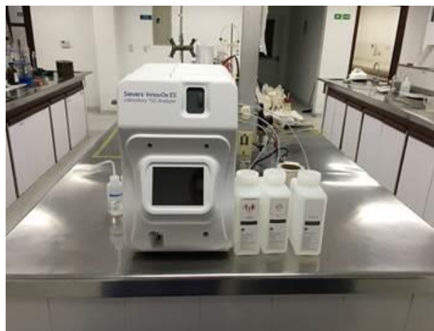
图 1. Sievers' InnovOx 实验室型 TOC 分析仪用于泄漏检测
