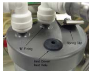
Figure 4 - Fill DI Water Reservoir
