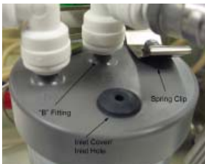
図 4 - DI 水リザーバーの補充
