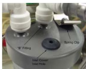
Figure 4 - Fill DI Water Reservoir
