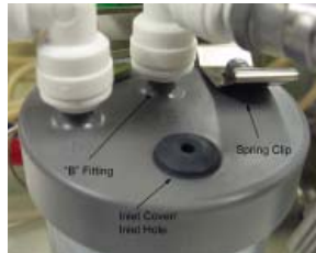
Figura 4 - Riempimento del serbatoio di acqua purificata
